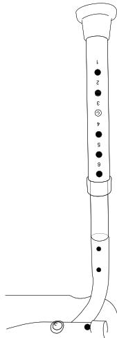
② 脚 B に脚 A を差し込み、スナップボタンと、穴の位置を合わせながら、高さを調節します。この時、全ての脚が同じ高さになるよう調節してください。
