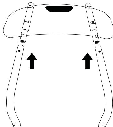
④ 背もたれのパイプ部分に、L字パイプを差し込みます。スナップボタンが、しっかり穴から出ていることを確認してください。
