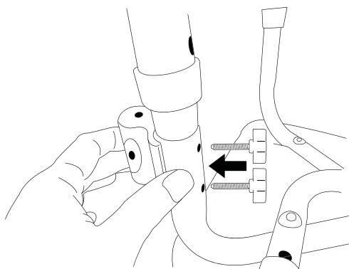
③ 座面四隅のパイプと脚 B の穴を合わせた部分に、連結パーツを取り付けます。反対側の穴からネジを差し込み、連結パーツを固定します。
