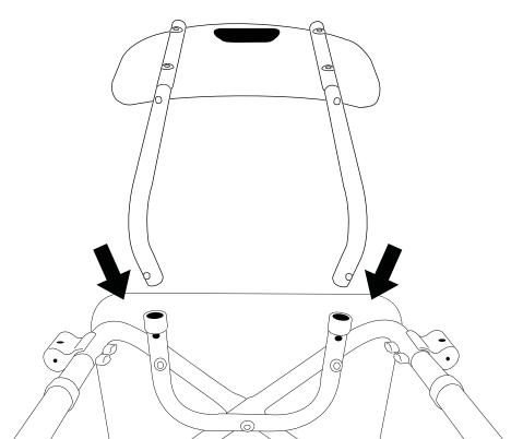
⑤ 背もたれに取り付けた L字パイプを、座面裏の U字パイプに差し込みます。U字パイプの穴から、L字パイプのスナップボタンが出ていることを確認してください。
