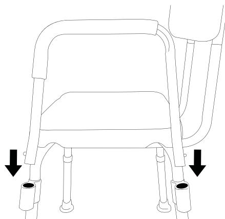
⑥ 連結パーツに、ひじ掛けを取り付けます。スナップボタンが連結パーツの穴から出るよう差し込んでいきます。反対側も同じように取り付け、完成となります。
