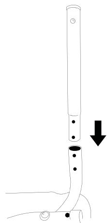
① 座面四隅のパイプ部分全てに、穴の位置を合わせるようにして、脚 B を差し込みます。
