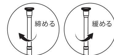
◆ 図のように左回りにひねると緩んで伸縮し、右回りにひねると締まって固定できます。
