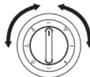
運転を停止する場合は、ダイヤルを「OFF」に合わせて運転を停止します。
