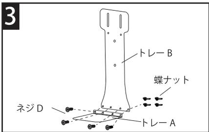
トレー A とトレー B の穴を合わせてネジ D を通して、蝶ナットで固定してください。
