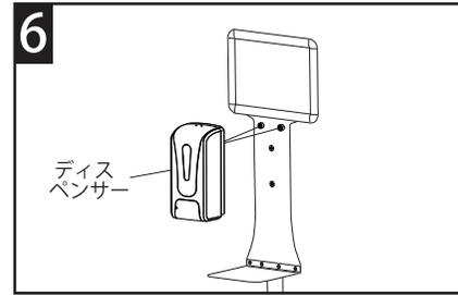
最後にディスペンサー本体をトレーに取り付け、ネジで固定して完了です。
