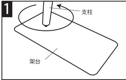
支柱を架台に回して、固定してください。
