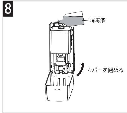
電池ボックスに単 2 電池 4 本を入れて、ディスペンサーの内部に消毒液を入れ、カバーを開けてください。
