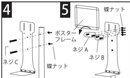
組み立てしたトレーと支柱の穴を合わせてネジ C を通して、蝶ナットで固定してください。
