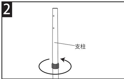
カバーキャップを回して、高さを調節します。
