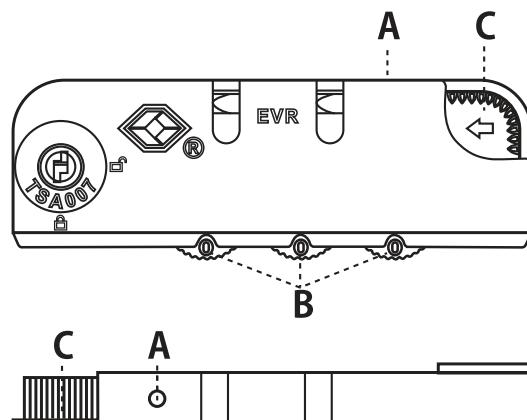
ロック解除番号を任意の番号に変更します。側面 A のボタンを先の細いもので押し込みます。その後 B のダイヤルを任意の番号にします。C のボタンを矢印の方向へ押し、A のボタンが戻れば完了です。
